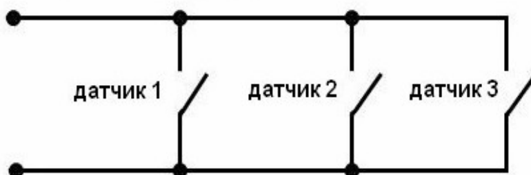
Схема 4.2. Тип шлейфа "на замыкание".
